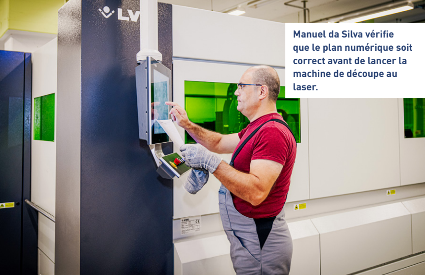
Ensuite, les plaques d'acier inoxydable sont découpées de manière entièrement automatisée selon plans.
